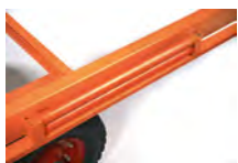
Rungen: herausnehm- und ablegbar in Halterung
